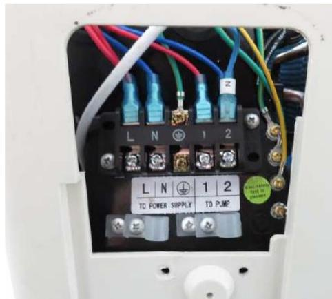
Terminais L e N : Entrada de energia elétrica 220 V ~ 60 Hz.
